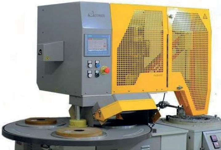
El equipo de fundición centrífuga **C3SPRO** es una instalación desarrollada por CONIEX S.A., después de más de 40 años de experiencia en el sector, con el objetivo de obtener la máxima productividad y calidad de producción en la fabricación de piezas en moldes de silicona.
